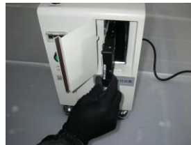
専用機器にてHDDを物理破壊
